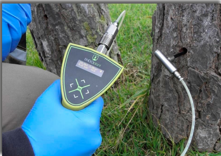
Imagen 13. Pistola de inyección en tratamiento por endoterapia de un ejemplar de Pinus halepensis (Endoterapia Vegetal SL)
