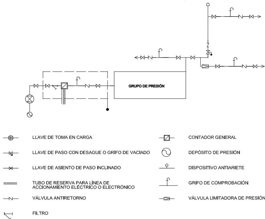
**Figura 3.1 Esquema de red con contador general**
