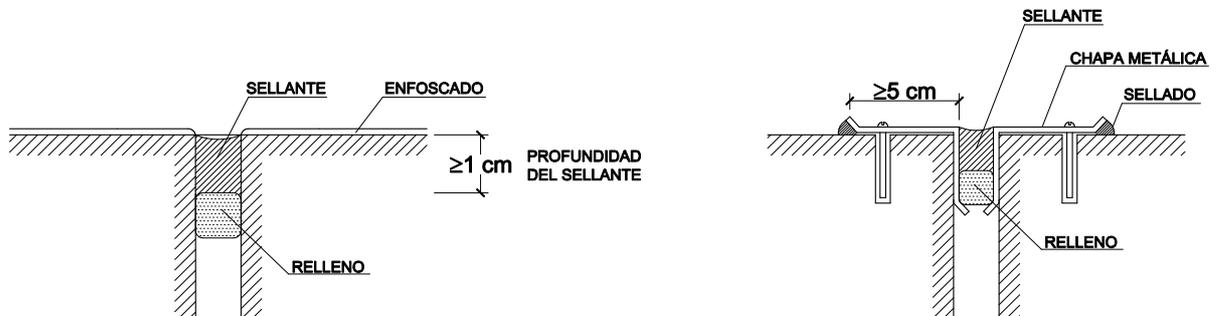
Figura 2.6 Ejemplos de juntas de dilatación
