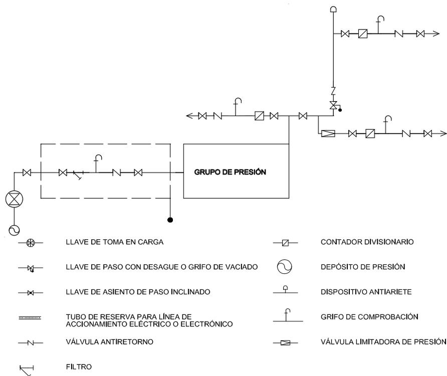
**Figura 3.2 Esquema de red con contadores aislados**
